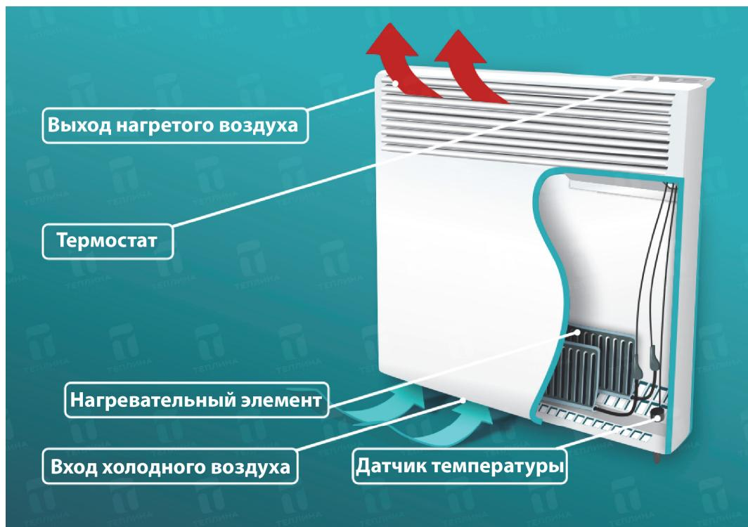
Принцип работы электрического конвектора достаточно прост. Конвектор – прибор, в котором теплопередача происходит за счёт естественного движения воздуха – конвекции: холодный воздух, вступая в контакт с электрическим нагревательным элементом, увеличивает собственную температуру, становится легче и выходит через фронтальную решётку, которая обеспечивает распределение тепла по всему помещению. За счёт циркуляции воздуха в пространстве комнаты очень быстро прогревается.
